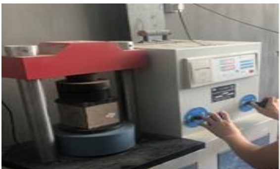
Hình 3. Thí nghiệm xác định cường độ chịu nén của CB - XM.
