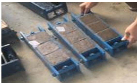
Hình 2. Đúc mẫu thí nghiệm xác định cường độ chịu nén.
