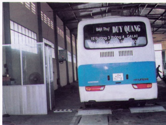
Kiểm tra thắng xe ô tô bằng thiết bị tự động. Automatic device checking brake safety for motor vehicles.
