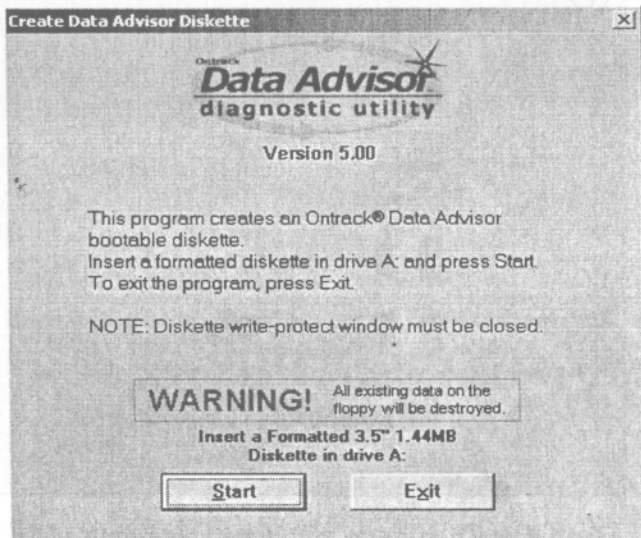
Hình 4.7: Tiến hành quá trình tạo đĩa mềm Boot.
