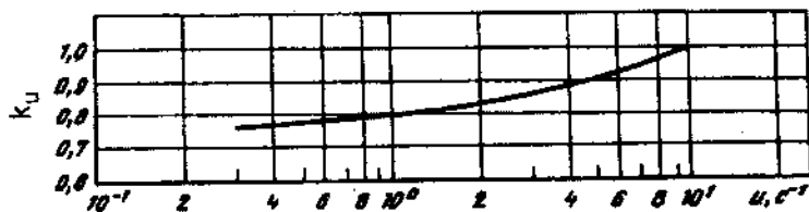
Hình II.81. Hệ số tốc độ k_u của thép 20XΓHM; \sigma_{0,d} = 9,5 \text{ kg/mm}^2
