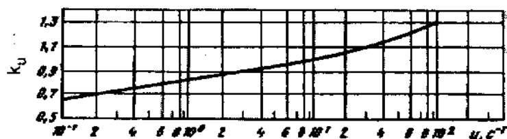
Hình II.117. Hệ số tốc độ k_u của hợp kim XH75MБTIO; \sigma_{0,d} = 22,2 \text{ kg/mm}^2
