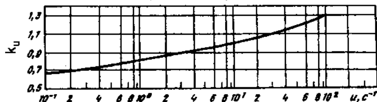
Hình II.114. Hệ số tốc độ k_u của thép XH78T; \sigma_{0,d} = 19,6 \text{ kgf/mm}^2
