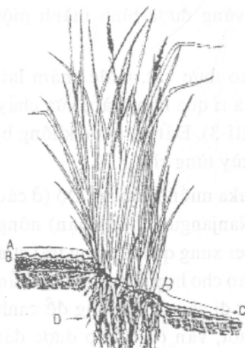
Hình (III-4): Thể hiện cắt ngang một hàng rào thực vật đồng mức đang làm việc của nó
