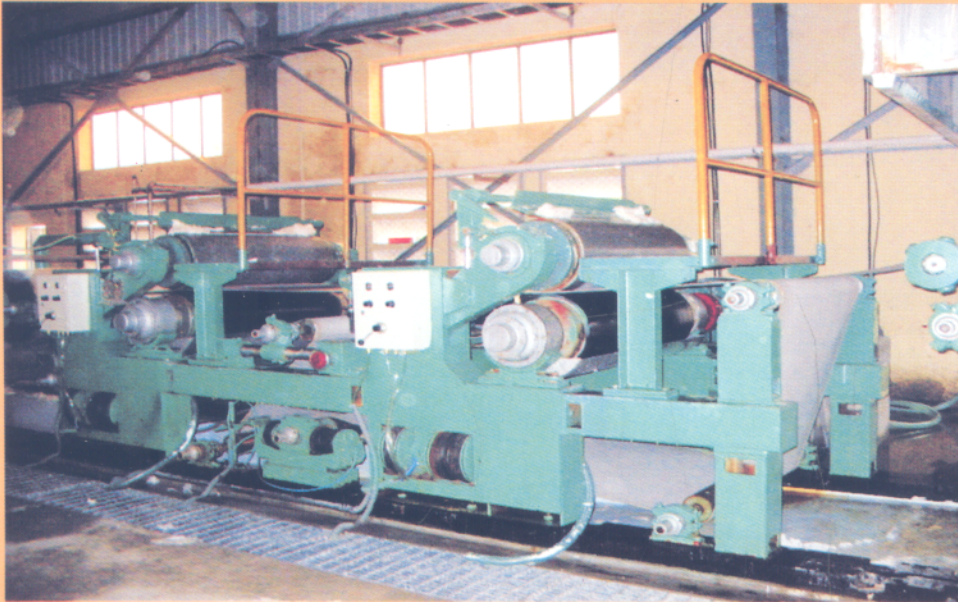
Hệ thống máy xeo giấy- thiết bị chính trong dây chuyền sản xuất giấy được sản xuất và tích hợp trong nước
