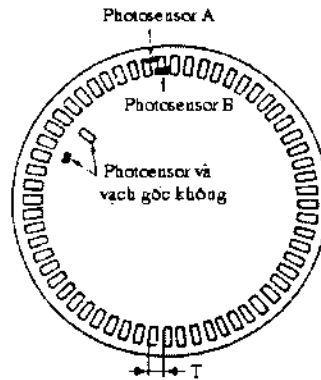
Hình 6-10 Bố trí photosensor để hình thành sóng A trượt pha so với sóng B góc 90^\circ .
