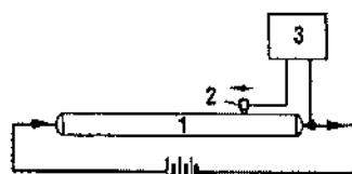
Hình 5-4: Sơ đồ phương pháp mũi dò di động: 1- mẫu đo; 2- mũi dò di động; 3- điện thế kế tự ghi.
