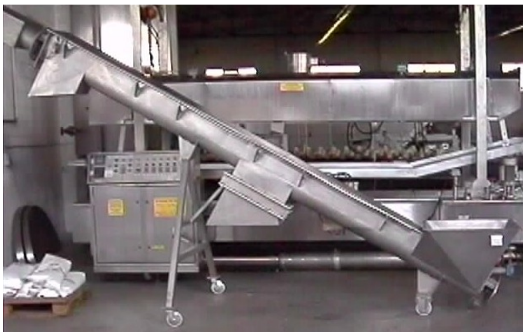
Hình 1 - 2. Vít tải nghiêng vận chuyển sản phẩm dạng bột
