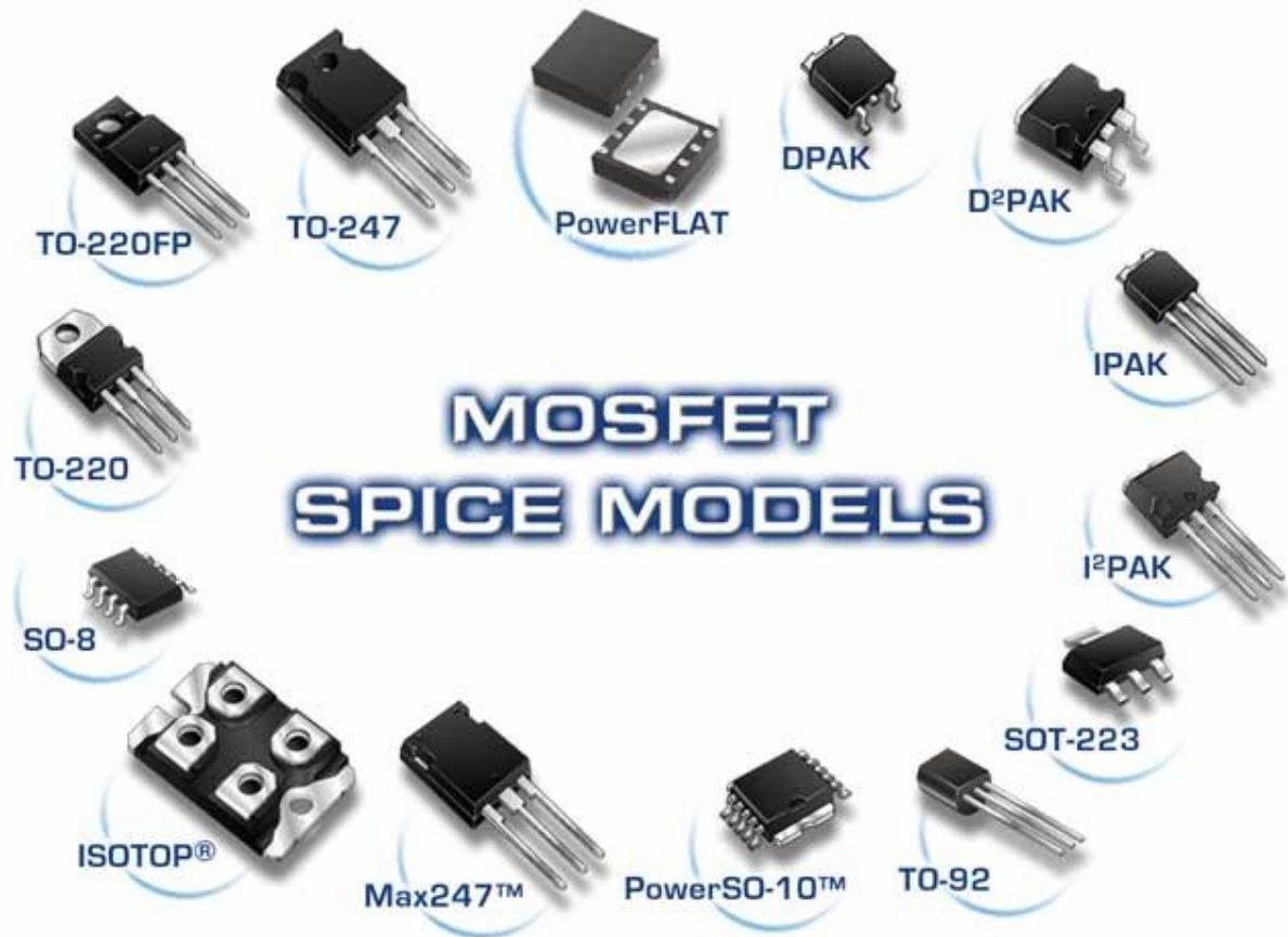
Hình 2.54b: Dạng đóng vỏ MOSFET trong thực tế
