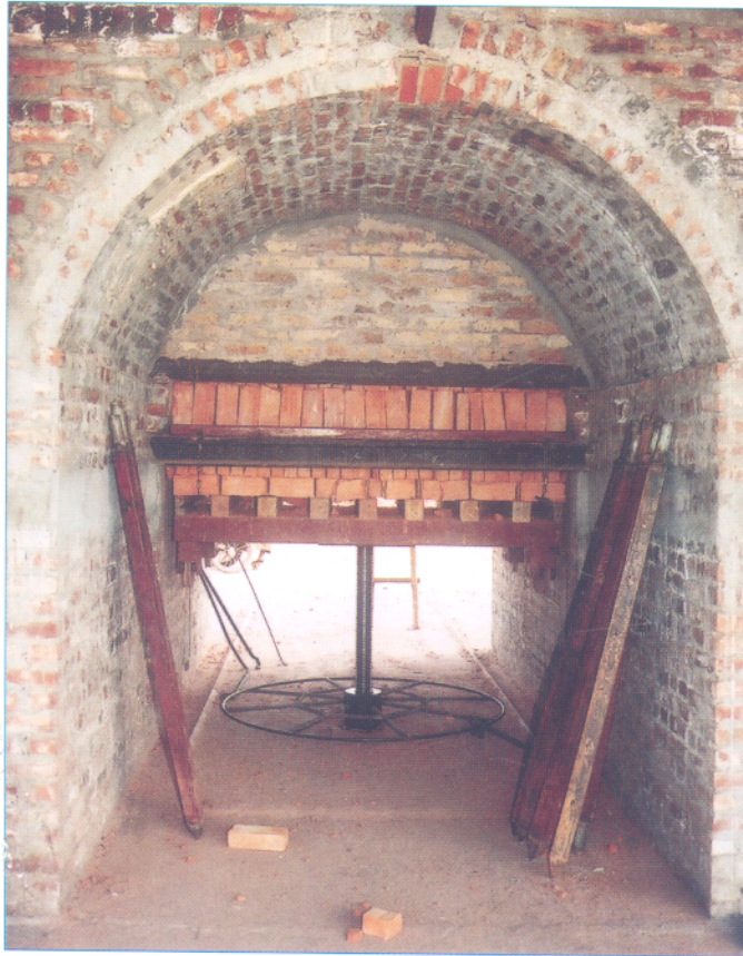
Vít nâng, hạ để lấy gạch ra khỏi lò (nhìn từ phía ngoài buồng nung gạch)
