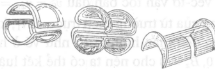
Hình 1.3: a- cuộn lái tia có lõi sắt, b- cuộn lái tia không có lõi sắt.
