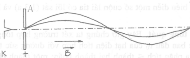
Hình 1.5: Quỹ đạo của hạt điện tử trong từ trường song song với trục của chùm điện tử phân kỳ yếu.
