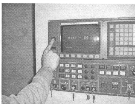
Cấp điện cho hệ thống điều khiển, động cơ trên máy
