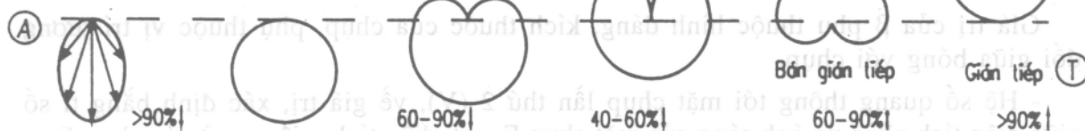
Hình 8-6a : Dạng đường cong cường độ ánh sáng theo đặc trưng phân bố ánh sáng của đèn. CIE phân thành 20 cấp từ trực tiếp định hướng A đến phân bố gián tiếp T.
