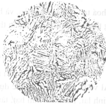
Hình 5.11. Tổ chức hợp kim CuAl9Fe4 sau đúc. Pha \alpha màu sáng, cùng tích phân theo biên giới
