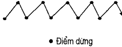
Hình 3-7. Chuyển động que hàn theo hình răng cưa
