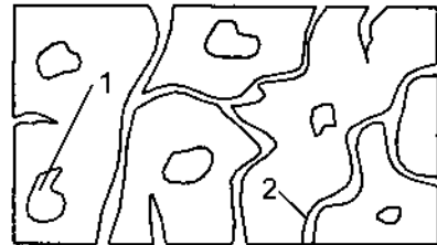
Hình 9. Cấu tạo các lỗ xốp trong vật liệu chịu lửa
