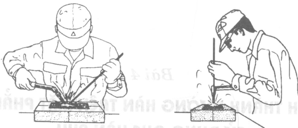
Hình 4.1. Các tư thế hàn có sử dụng que hàn phụ
