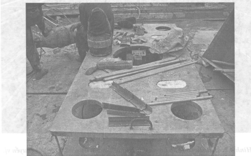
Hình 4.1a: Các tấm thép trên và dưới của HTT Osterberg;
