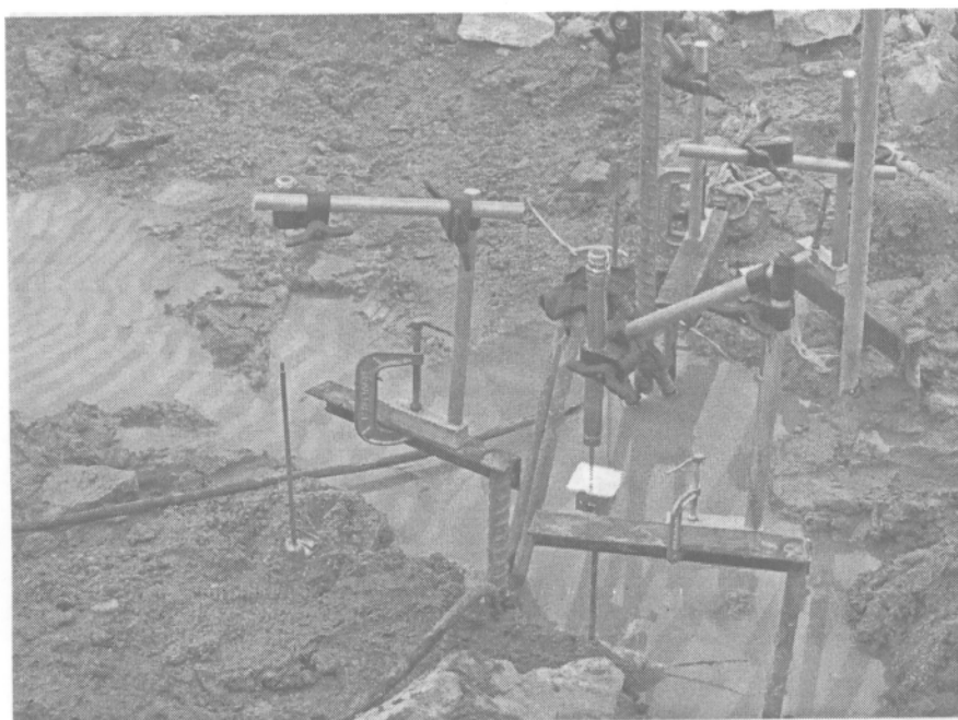
Hình 4.7: Đầu đo lắp vào thép đầu cọc, chân tỳ vào thanh truyền để đo chuyển vị các chi tiết của hộp kích Ocell dưới đáy cọc
