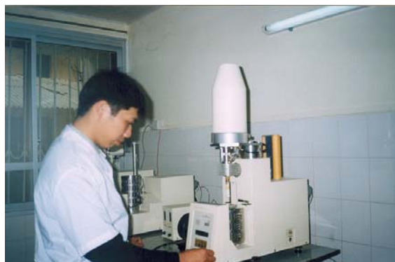
Đánh giá độ bền nhiệt của vật liệu cao su blend bằng phương pháp TGA tại Viện Hóa học
