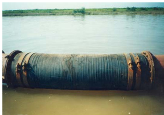
Sản phẩm ống đẩy chịu áp lực cho tàu nạo vét sông, biển được lắp đặt tại công trình
