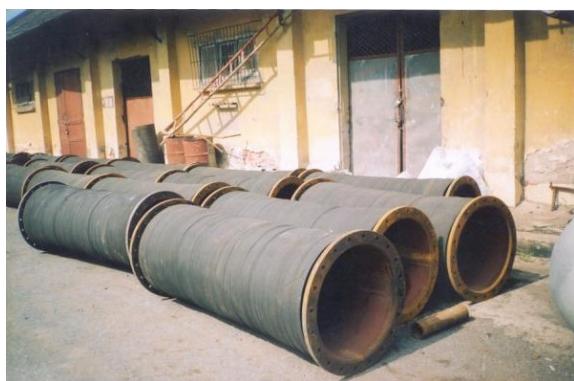
Sản phẩm ống đẩy chịu áp lực vừa ra khỏi lò lưu hoá
