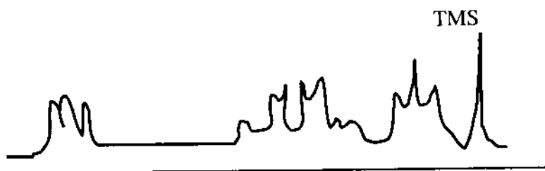
Hình 5-9. Tín hiệu PMR của rượu etylic với máy có năng suất phân giải cao.
