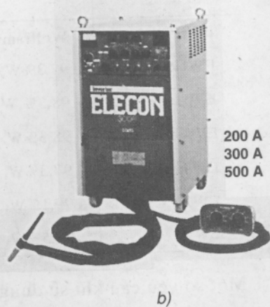
Hình 3-15. Thiết bị dùng cho hàn TIG a) Sơ đồ thiết bị ; b) Máy hàn TIG
