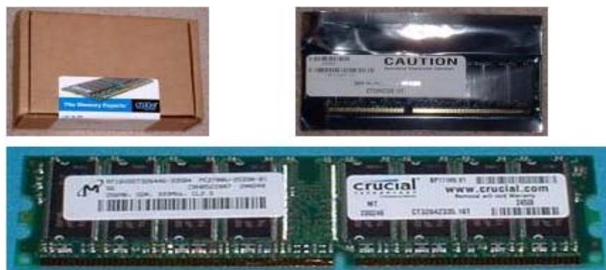
Hình dạng bộ nhớ hệ thống được đóng gói trong bao chống tĩnh điện
