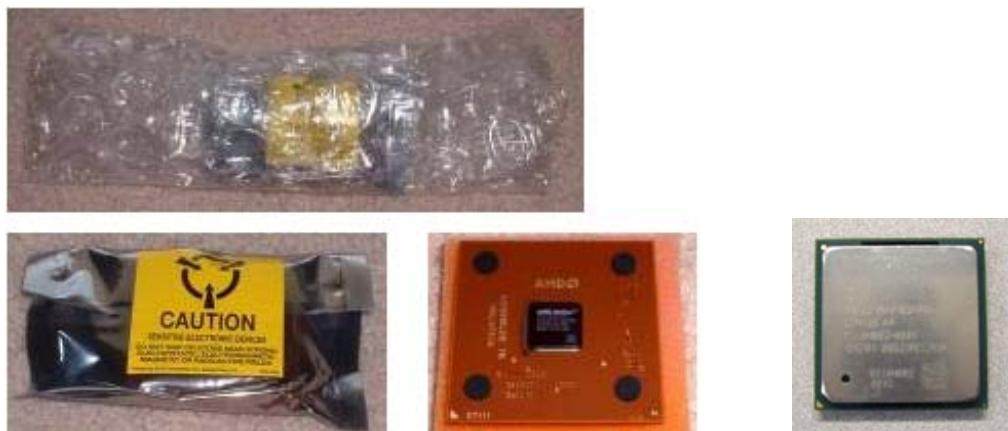
Dạng đóng gói OEM bộ xử lý. BXL cắm trên miếng xốp mỏng để tránh cong chân, được đóng trong túi chống tĩnh điện và được bao quanh bằng tấm gói có bọt khí.
