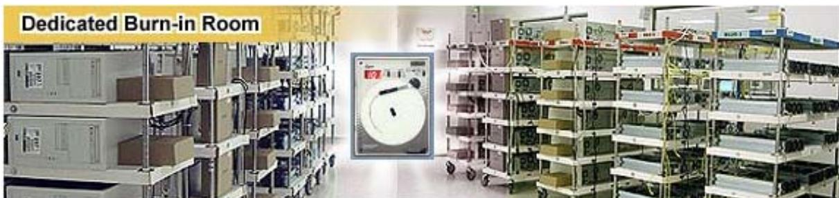
Bên trong Gian thử nhiệt kiểm soát được nhiệt độ với giá để máy có bánh xe
