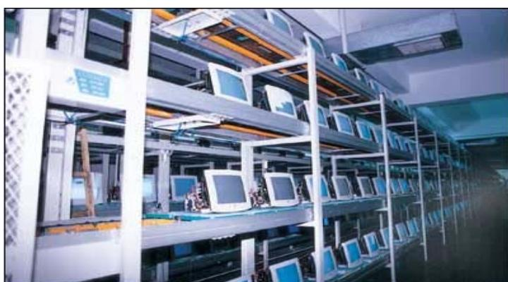
Bên trong Gian thử nhiệt kiểm soát được nhiệt độ với 4 tầng băng tải
