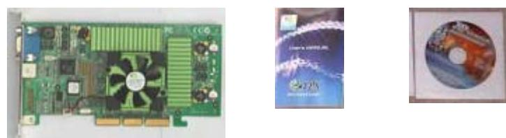
Hình dạng video card và phụ kiện kèm theo (đĩa driver, hướng dẫn sử dụng)
