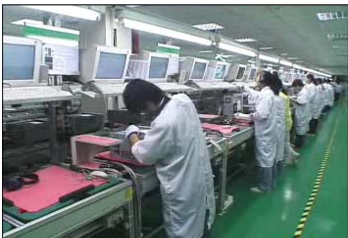
Dây chuyên lắp ráp với vị trí công tác test
