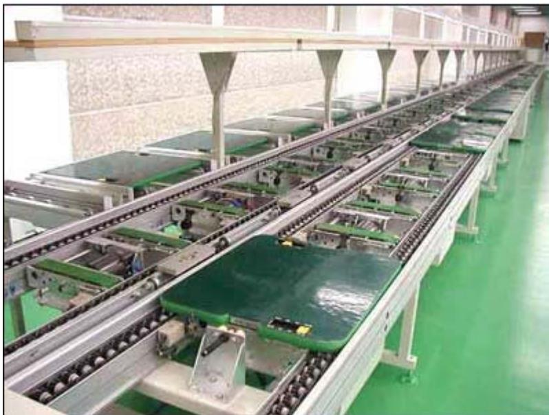
Dàn con lăn với tấm đặt máy chống phóng tĩnh điện (ESD)
