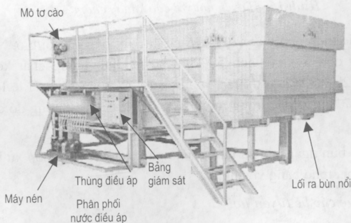
Hình 167: Bể tuyển nổi chữ nhật
