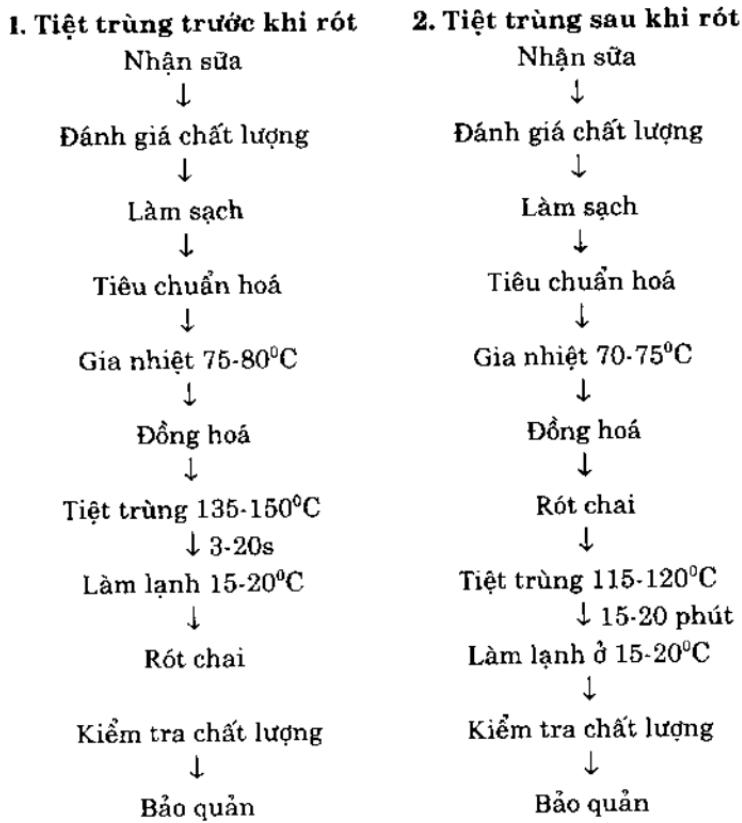
Quy trình sản xuất sữa tiệt trùng trước khi rót chai thường được thực hiện như sau: Sữa đã được làm sạch và tiêu chuẩn hóa được đưa vào thiết bị gia nhiệt đến 75-80°C rồi qua tiệt trùng ở 135-150°C trong 3-2s. Sau đó sữa được nhanh chóng làm nguội tới 15-20°C và rót vào chai trong điều kiện vô trùng: Quá trình đồng hóa có thể tiến hành trước hoặc sau khi tiệt trùng, với điều kiện phải đảm bảo vô trùng.
