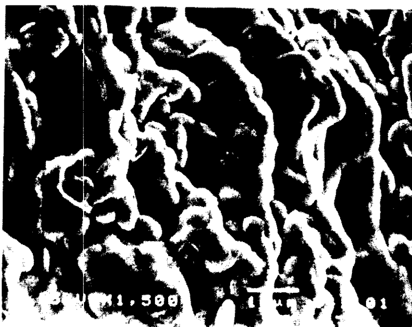
Hình 4. Ảnh chụp hạt xúc tác sinh học sau khi lên men qua kính hiển vi điện tử cắt lớp JEOL-JSM 10 LV, Nhật.
