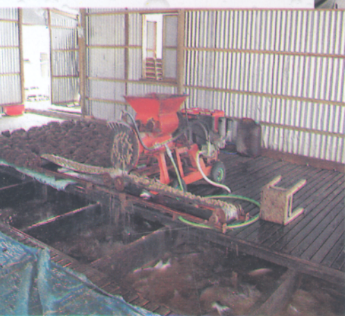
Hình 28: Cho cá nuôi trong bè ăn thức ăn tự chế biến Trên: Cho ăn bằng tay Dưới: cho ăn bằng máy ép đùn thức ăn
