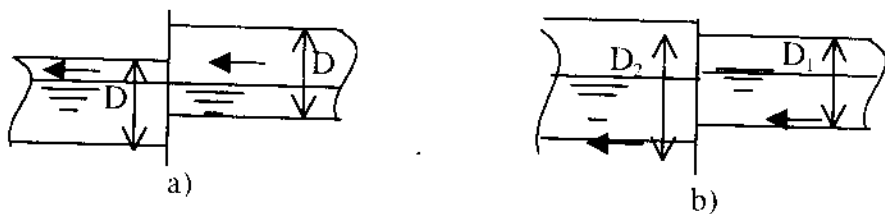
Hình 2.4: Nối ống, cống thoát nước sinh hoạt trong các giếng thăm a. Nối theo mặt nước; b. Nối theo đỉnh cống.
