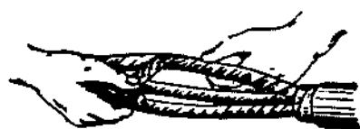
Hình 4-32. Vị trí đúng của cuộn (puli) băng cách điện trong tay khi quấn cách điện giấy.
