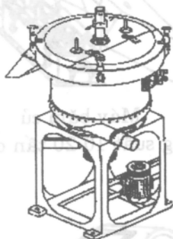
Máy trích ly (Công suất 1,5 tấn tinh bột sẵn khô/giờ)
