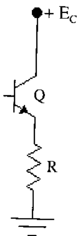
Hình 1.11. Cách cấp điện cho cực Emitter dùng R
