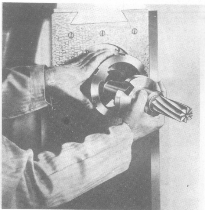
Hình 9. Các dao được khóa vào trục chính với một vòng quay nhỏ của vòng kẹp.
