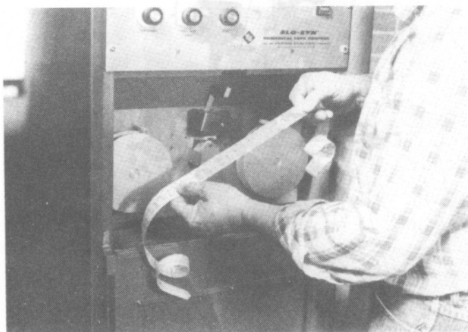
Hình 2. Máy phay điều khiển số với thông tin được cất giữ trong một băng đục lỗ.
