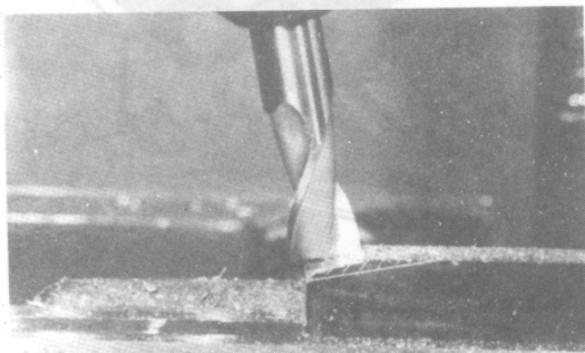
Hình 17. Cắt một góc bằng cách xoay đầu máy và sử dụng các răng mặt đầu của một dao phay ngón.
