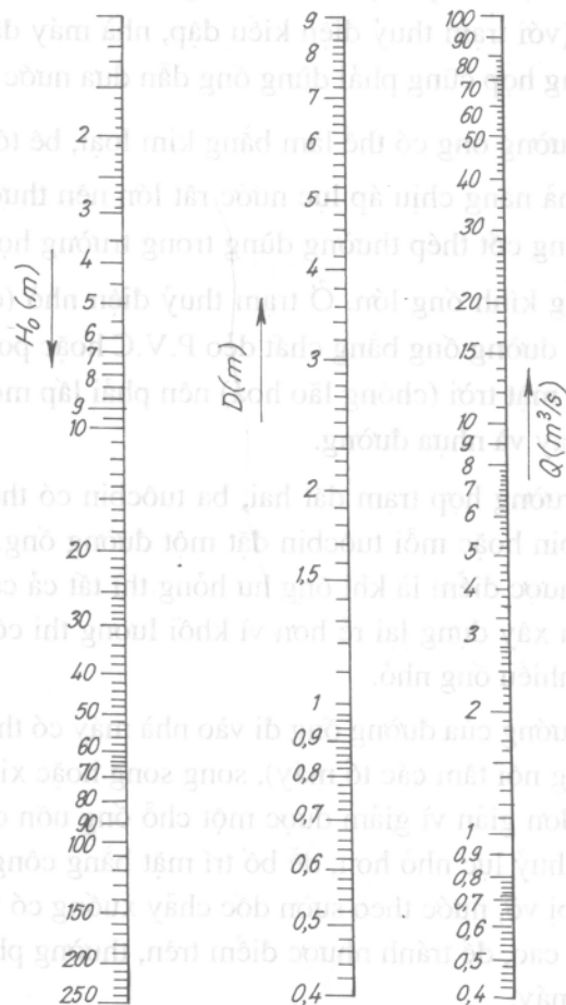
Hình 3.17: Biểu đồ xác định đường kính ống dẫn lợi nhất
