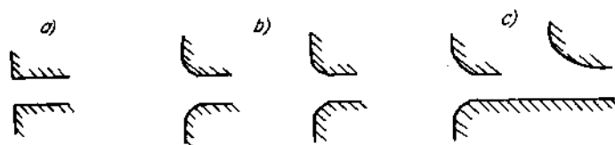
Hình 3.18: Hình dạng miệng vào của ống dẫn a) Vuông góc; b) Vát cạnh hoặc sửa tròn; c) Hình miệng loa
