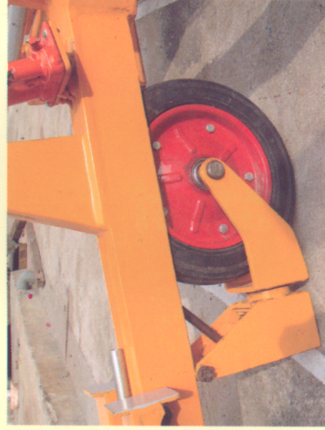
Gập bánh xe chuyển hướng để kéo xe ra cáp bằng ô tô
