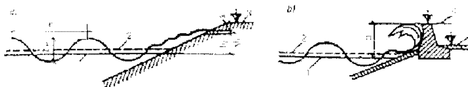
Hình 1-9. Sơ đồ tính toán cao trình đỉnh đập đất
