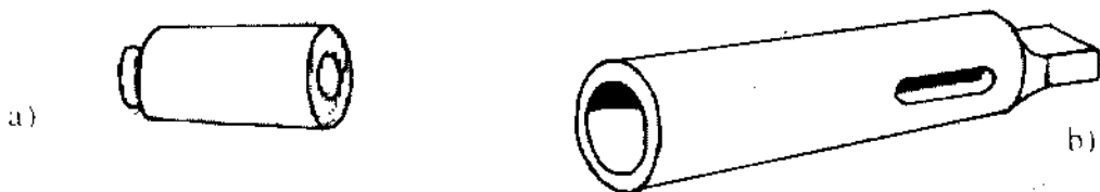
Hình 1 - 30 a) Áo côn ở trục chính b) Áo côn trung gian ở ụ động
