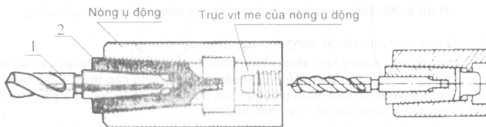
Hình 4 -81: Lắp bạc côn trung gian vào lỗ côn ở nòng ụ động
