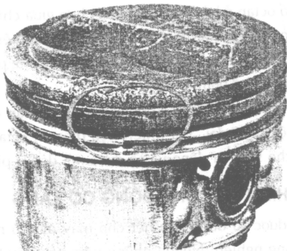
Hình 5: Cháy nổ làm hỏng piston này và làm vỡ vòng thứ 2. Vòng trên cùng bị kẹt và gãy.
