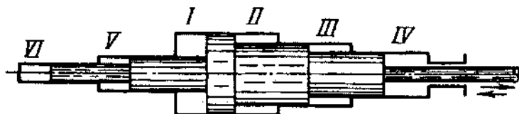
Hình 8.7 – Sơ đồ máy nén nhiều cấp piston vi sai
