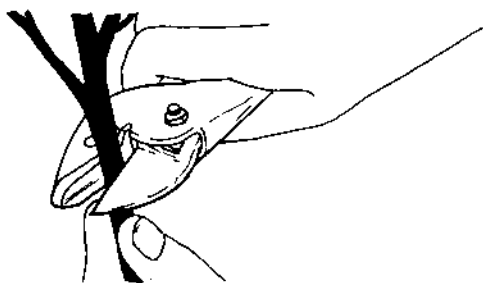
Hình 11: Các loại kéo cắt cành và cách sử dụng
