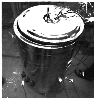
Hình 3.3: Đặt khay mẫu vào thùng đoạn nhiệt, nối cảm biến với máy đo
