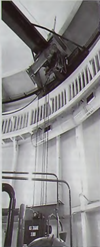
Cán cấu xoay tròn độc đáo trên đường ray dọc theo tường ở cao độ 12 m trong gian nhà lò.
