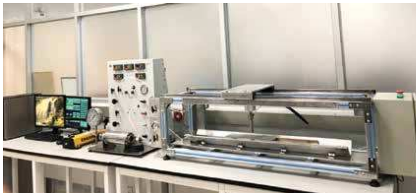
Hình 2. Hệ thiết bị đo độ thấm khí đa năng.
