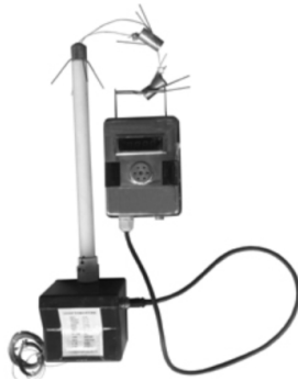
a) Bộ thu thập dữ liệu b) Cảm biến dịch chuyển c) Cảm biến lực căng thanh neo d) Cảm biến áp lực thanh neo
