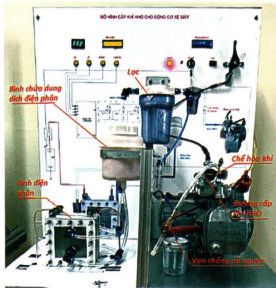
Hình 3.3. Mô hình cấp khí HHO cho động cơ xe máy
