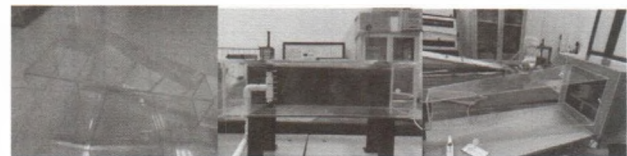
Hình 2.4: Chế tạo phần buồng lắng, nón co, phần quan sát và buồng khuếch tán
