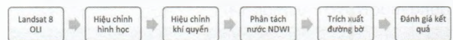
Hình 3.1: Lưu đồ trích xuất đường bờ từ ảnh vệ tinh đa phổ Landsat 8
