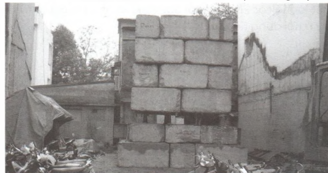
Hình 4.1: Thí nghiệm nén tĩnh tải cọc khoan nhồi đường kính nhỏ
