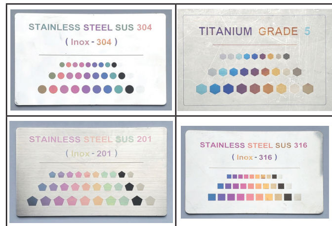
Hình 6. Mẫu thử nghiệm khắc laser tạo màu trên các vật liệu: inox 304, 201, 316 và hợp kim titan grade 5.
