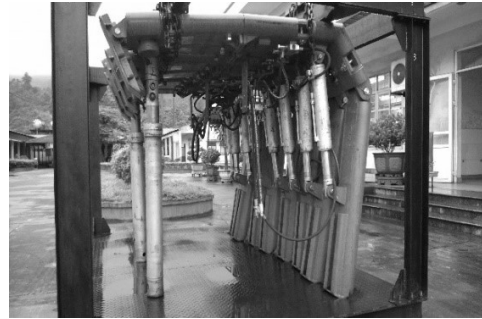
Hình 2. Giàn chống mềm loại ZRY
