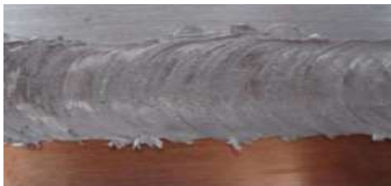
Hình 4. Tấm bimetal Cu/Al được chế tạo xong
